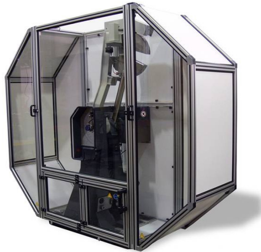
Ph1 : Mouton de Charpy 750 joules, dispositif utilisé pour la mesure de la résilience des aciers (tiré du cours Produits Procédés et Matériaux de X. Pessoles 2013)
